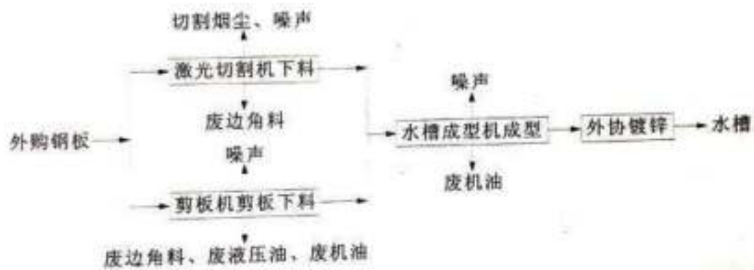
图 3-4 项目水槽生产工艺流程及产污环节示意图
