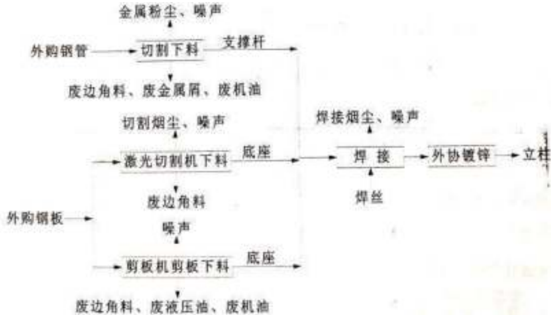
图 3-2 项目立柱生产工艺流程及产污环节示意图
