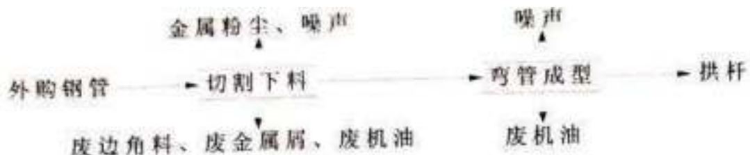
图 3-3 项目拱杆生产工艺流程及产污环节示意图
