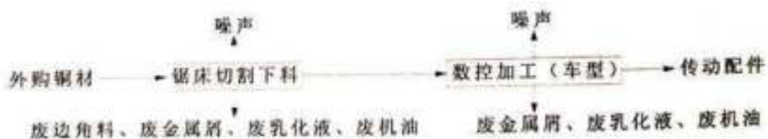
图 3-5 项目传动配件生产工艺流程及产污环节示意图
